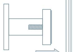
Verklebung mit Klebeadapter für M4/M6 Gewinde – für alle glatten Oberflächen wie z.B. Glas und Keramik geeignet – bei Bestellung bitte angeben
