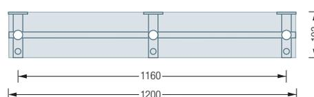
\*Edelstahl-Senkkopfschraube  $d7 \times 60$  mm mit Rahmendübel 10 mm (HRD-CR 10 x 60).
