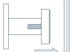
Verklebung mit Klebeadapter für M4/M6 Gewinde – für alle glatten Oberflächen wie z.B. Glas und Keramik geeignet – bei Bestellung bitte angeben
