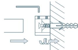
Ohne Wandlager ist eine direkte Verschraubung in optisch reduzierter Form möglich: Die Stangenenden werden mit zwei M6 Innengewinden und mittels M6 Stockschrauben verschraubt
