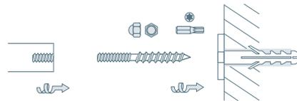
Rückseitige Verschraubung\* – Bohrung in Paneel  $\varnothing 6$  mm
