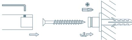
Beidseitige Verschraubung\* – Bohrung durch Paneel  $\varnothing 6$  mm
