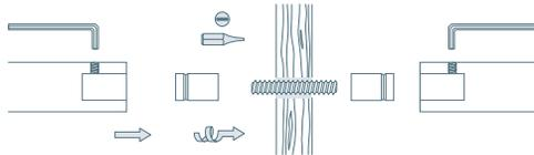
Wandverschraubung mit Rosette – Bohrung in Wand  $\varnothing 6/8$  mm
