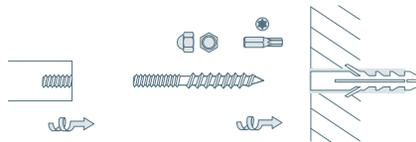
Wandverschraubung mit Rosette – Bohrung in Wand  $\varnothing 6/8$  mm
