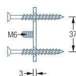
\*Edelstahl-Senkkopfschraube d 7 x 60 mm mit Rahmendübel 10 mm (HRD-CR 10 x 60).
