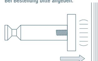
Verklebung mit Klebeadapter für M4/M6 Gewinde – für alle glatten Oberflächen wie z.B. Glas und Keramik geeignet. Bei Bestellung bitte angeben.
