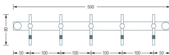
\*Material: PE (Polyethylen), matt schwarz. Hohe chemische Beständigkeit, gute Gleitfähigkeit.
