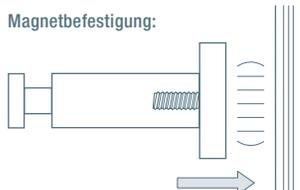
Wandhaken HN20-70 in Kombination mit Topfmagnet (vernickelt) mit Gewindezapfen, Haftkraft ca. 38 kg – bei Bestellung bitte angeben
