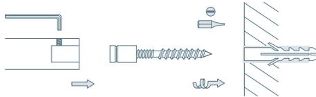
Rückseitige Verschraubung\* – Bohrung in Paneel  $\varnothing 6/8$  mm
